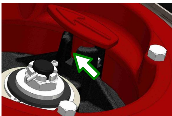
Obr. 26: Mazací místo - palec volonoběžného náboje kola
